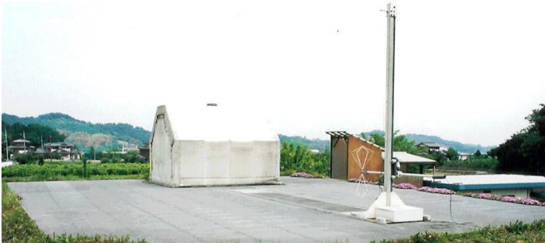
写真 1. 電磁波測定場、オープン・サイトの例
