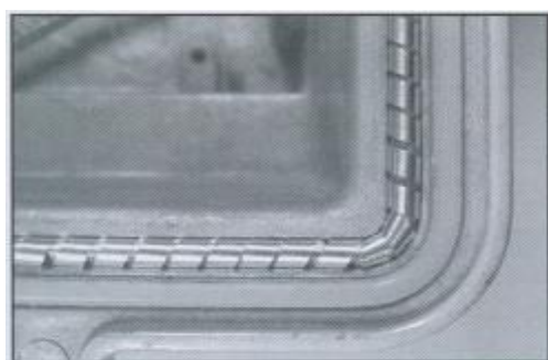
写真 19 スパイラル・スプリング・ガスケットの装着例
