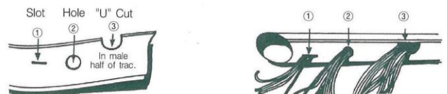
図 12 ビニル・ジッパー結束時の分岐方法
