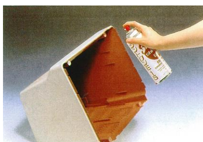
写真3 エアゾール缶型導電塗料による塗装風景
