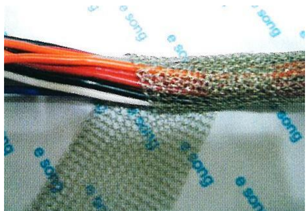
写真28 ワイヤーマッシュ・テープによるシールド法の例
