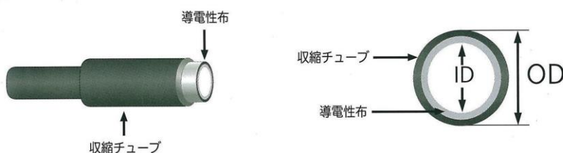
図 13 熱収縮型シールド・チューブの構成とサイズの説明
